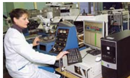
Зондовые измерения УЭП на пластине
