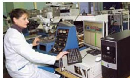
Зондовые измерения УЭП на пластине
