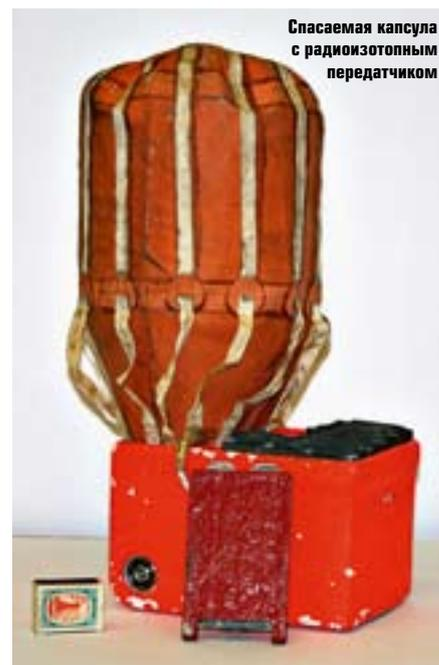
Спасаемая капсула с радиоизотопным передатчиком
